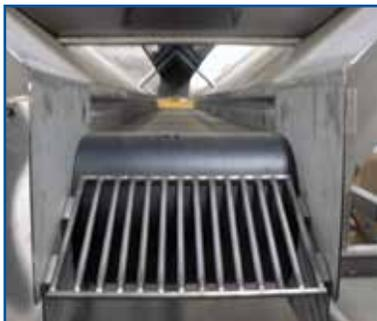
Extremo de descarga de una banda de descarga de una BULK BIN bandeja.
