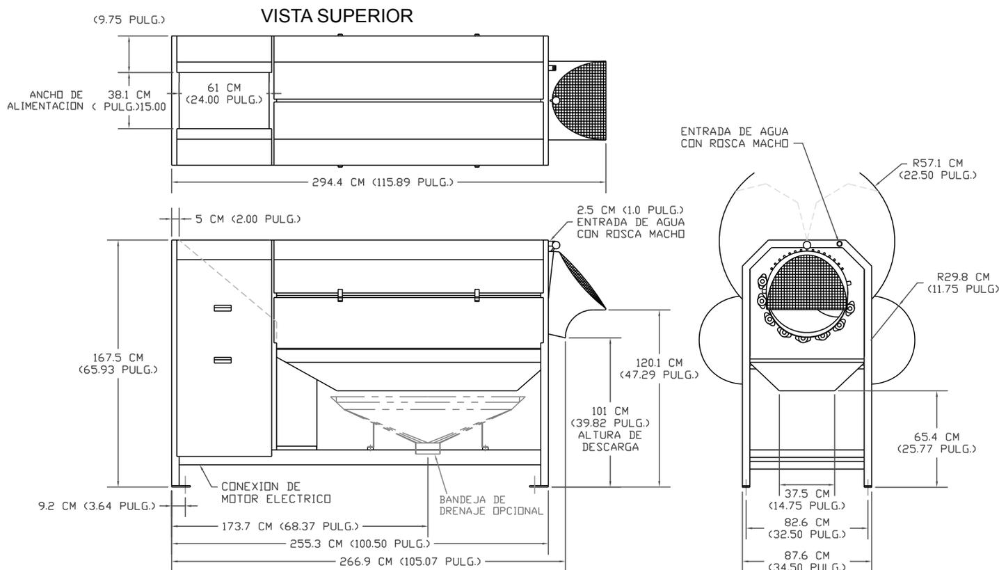
NOTA: REQUIERE UN ACCIONAMIENTO DE FRECUENCIA PROPORCIONADO POR EL CLIENTE PARA EL CONTROL DE LA VELOCIDAD.
